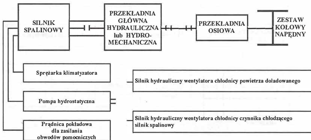
Rys.1. Schemat układu napędowego z wykorzystaniem przekładni głównej hydraulicznej lub hydromechanicznej
